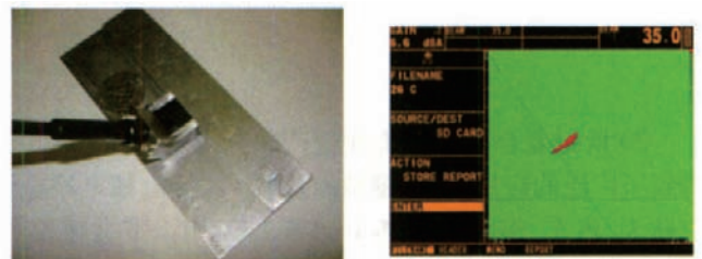
图4 飞机蒙皮疲劳裂纹的检测实例
